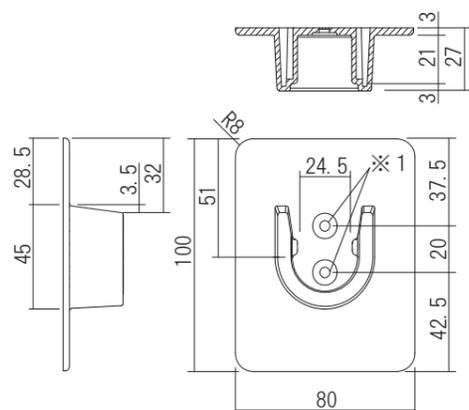
注1:安装时可以钻孔,并使用双面胶和螺丝固定。
