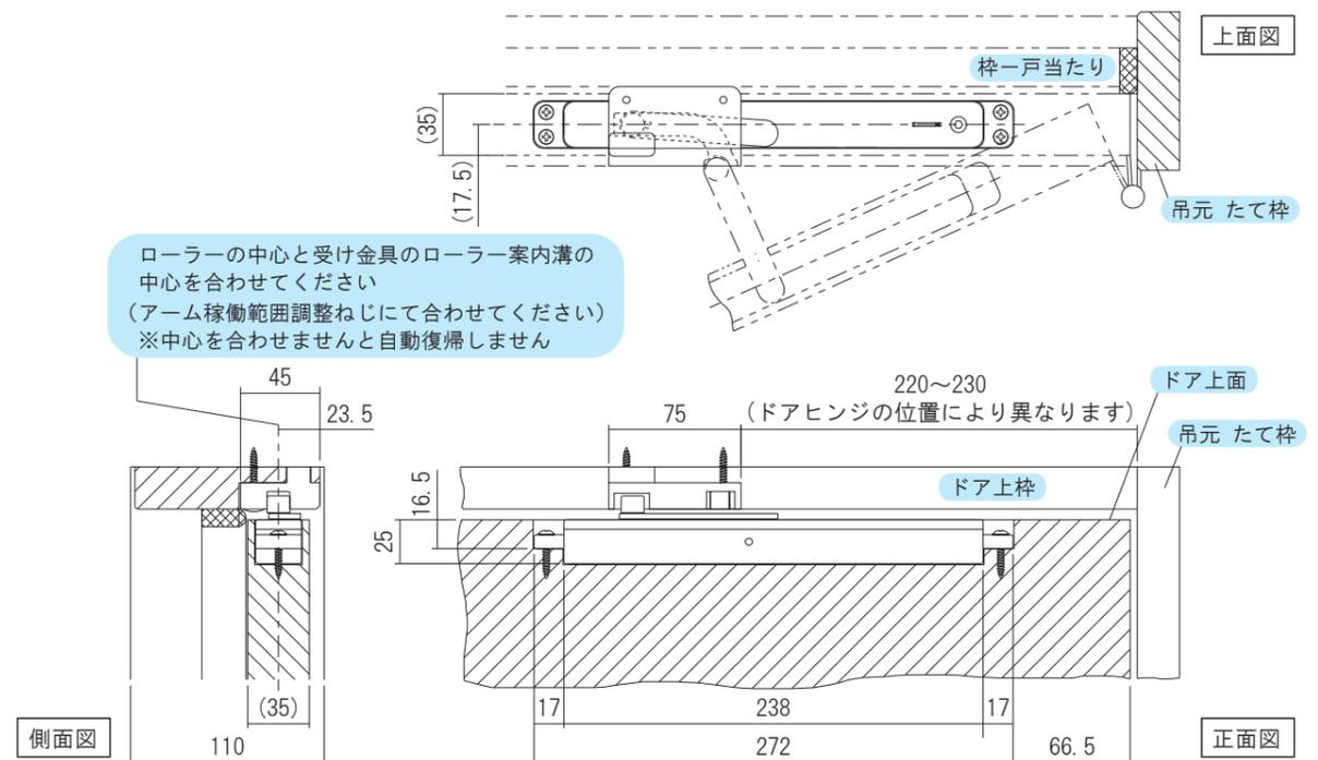
取付参考図 (図はR勝手でドア厚み35mmの場合を示します)
