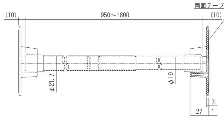
注1:取付時に穴あけし、両面テープ固定とねじ固定を併用することができます。
