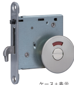
上鎌錠 BS51 ストライクに鎌が上からかかります。バックセットは 51mm です。
