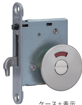
上鎌錠 BS38 ストライクに鎌が上からかかります。バックセットは 38mm です。
