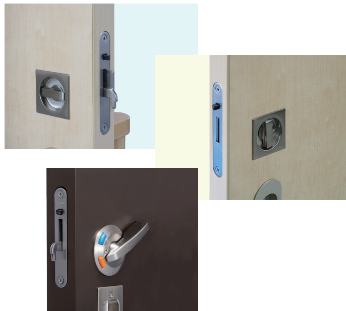
デッドボルト錠 BS51 ストライクに鎌が上からかかり、同時にデッドボルトが突出します。バックセットは 51mm です。
