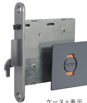
デッドボルト錠 BS51 ストライクに鎌が上からかかり、同時にデッドボルトが突出します。バックセットは 51mm です。
