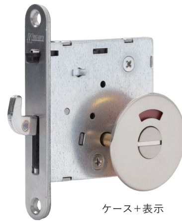
下鎌錠 BS51 ストライクに鎌が下からかかります。バックセットは 51mm です。
